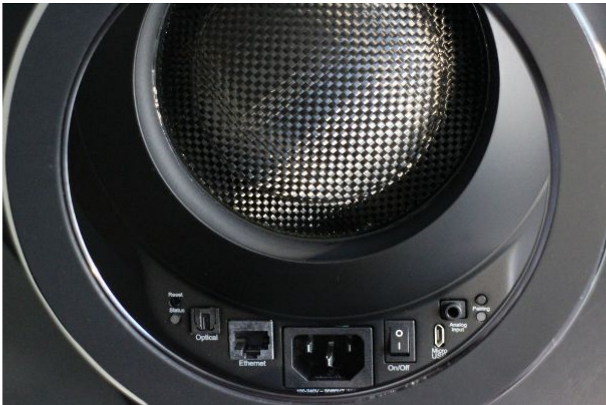
Ansicht Sub von unten: aussen der Standfuss, im Zentrum das Anschlussfeld und die Carbon-Membran des 17-cm-Tieftöners.
